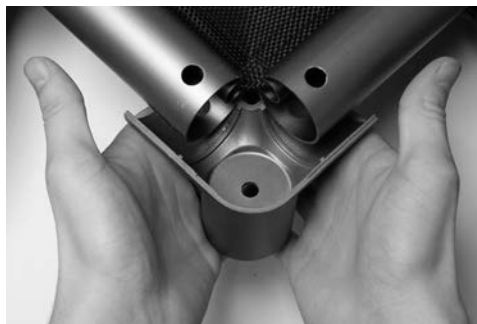
Fig. 6.7.1. Montaje de la última esquina - paso 1
