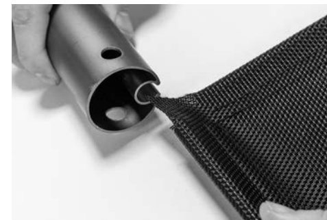
Fig. 6.5.3. Insertar en la guía del tubo
