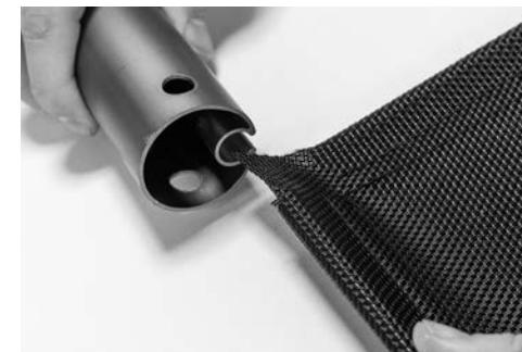
Abb. 6.5.3. In die Kederführung vom Rohr einführen
