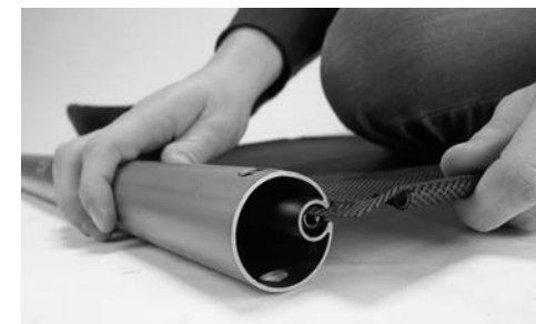
Fig. 6.5.4. Pousser le tube sur la longueur du filet.
