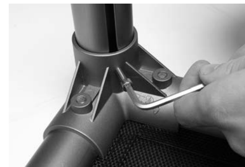
Fig. 6.9.2. Apriete el tornillo para las patas
