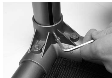
Abb. 6.9.2. Schraube der Beine anziehen
