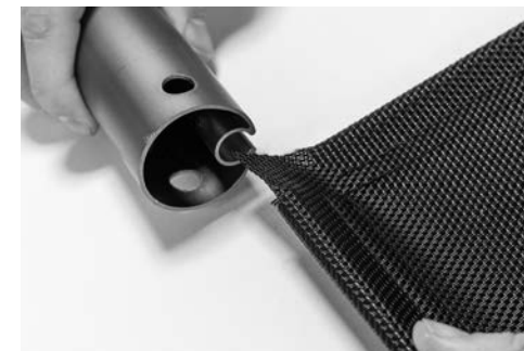
Fig. 6.5.3. Introduire dans le guide de bourrelet du tube
