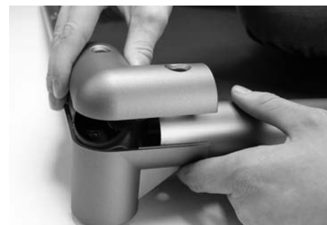
Fig. 6.6.4. Mise en place de la pièce d'angle supérieure
