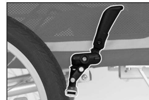
Abb. 5.5.1. Feststellbremse angezogen. DogBus-Ansicht in Fahrtrichtung rechts.
