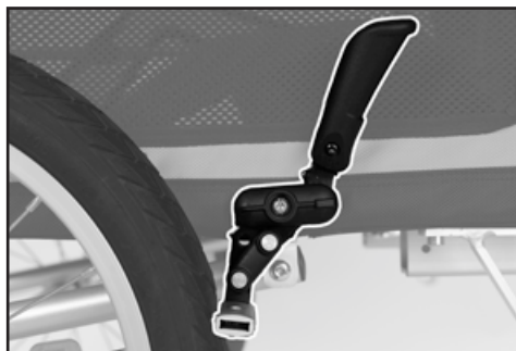
Fig. 5.5.1. Freno di stazionamento azionato. Vista del DogBus dal lato destro in direzione di marcia.
