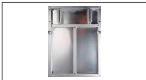
Abb. 5.9.1. Unterboden des DogBus. Die zwei Einschubmöglichkeiten sind im oberen Teil des Bildes gut sichtbar.
