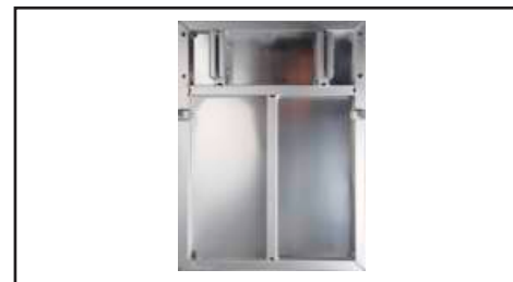
fig. 5.9.1. Fondo del DogBus. Las dos ranuras de inserción son claramente visibles en la parte superior de la imagen.
