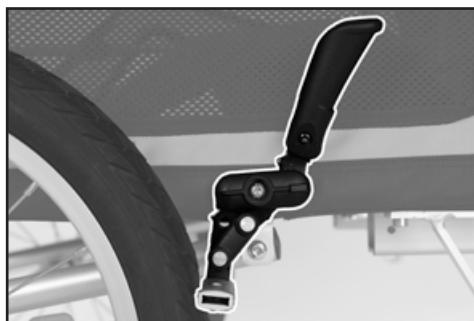
fig. 5.5.1. Freno de estacionamiento activado. Vista del DogBus en dirección de marcha, lado derecho.
