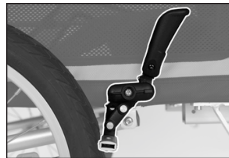
Fig. 5.5.1. Frein de stationnement serré. Vue du DogBus du côté droit dans le sens de la marche.
